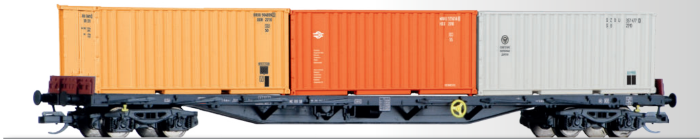
Containertragwagen Rgs 3910 der DR, beladen mit drei 20' Containern Container car Rgs 3910 of the DR with three 20' container
