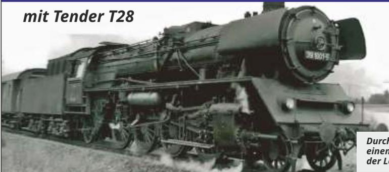
Neukonstruktion, Chassis, Kessel und Tendergehäuse aus Zinkdruckguss
