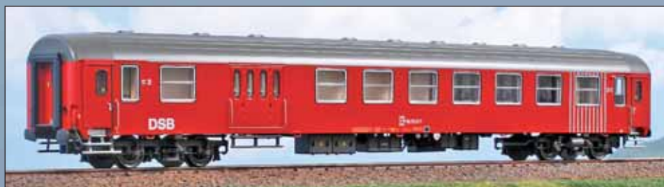
Carrozza DSB Tipo UIC-Y, mista di seconda classe e bagagliaio. DSB Type UIC-Y 2 nd class/luggage car. DSB-Wagen Typ UIC-Y, gemischte zweite Klasse und Gepäckabteil.
