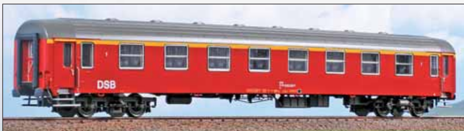
Carrozza DSB Tipo UIC-Y di prima classe (prima ordinazione), per servizio internazionale, con porte originali. DSB Type UIC-Y 1 st class passenger car for international service (first order), original doors. Personenwagen 1. Klasse Typ UIC-Y der DSB (erste Bestellung), für den internationalen Verkehr, mit Originaltüren.
