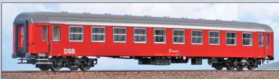
Carrozza UIC-Y di seconda classe, per servizio interno, con porte originali. DSB Type UIC-Y 2 nd class passenger car for internal service, original doors. Personenwagen 2. Klasse Typ UIC-Y der DSB, für den internen Dienst, mit Originaltüren.
